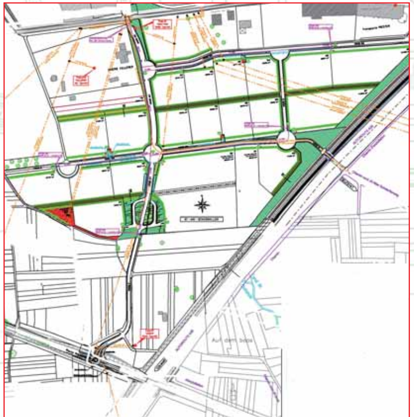
Lignes électriques aériennes devant être mises en souterrain.
